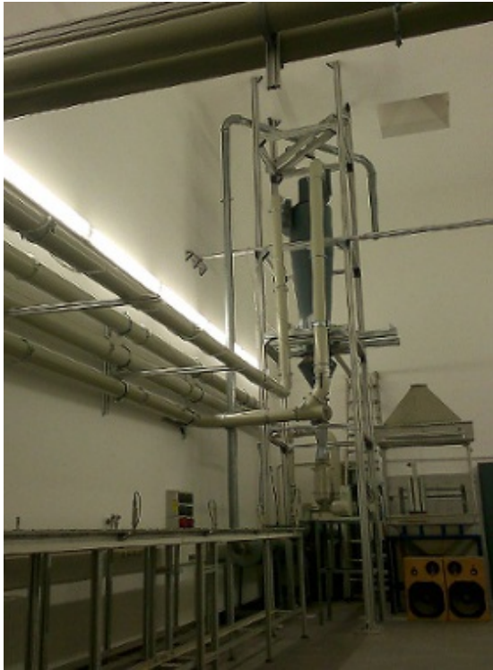
Flachkanal für die Experimentelle Untersuchung der pneumatischen Förderung
