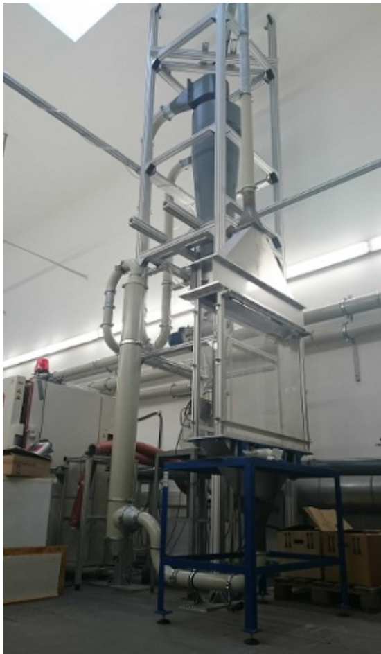
Laborsprühtrockner zur Untersuchung der Wechselwirkung (Kollisionen) trockener Tropfen durch Verwendung zweier Wechselwirkender Flachstrahldüsen.
